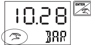
Figure: Affichage après passage dans le mode manuel
