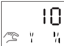
Figure: Affichage du taux d'impulsion de la vanne
