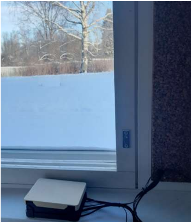
Kuva: Mikrokontrolleri ikkunalaudalla. Anturikaapelit menevät elementin sisälle.
